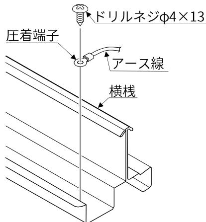
図 6-2. YS III での架台のアース接続
