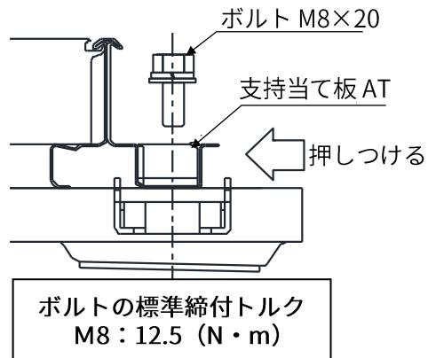
図3-10. YSIII工法 横桟の固定図
