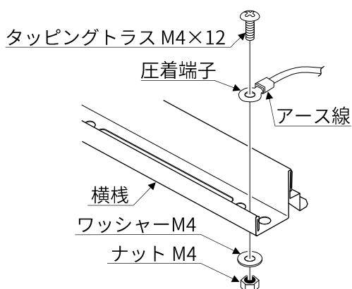
図 6-1. YS II での架台のアース接続
