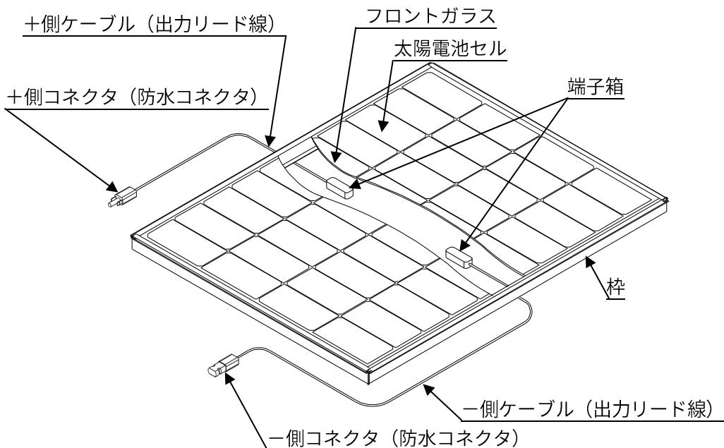
※本製品のケーブルは+側と-側で長さが異なります。接続するケーブル同士が届く範囲にあることを十分ご確認のうえ、配置してください。詳細は設置工事マニュアル、架台同梱の設置注意書面をご確認ください。
