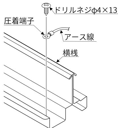
図4-2. YS IIIでの架台のアース接続
