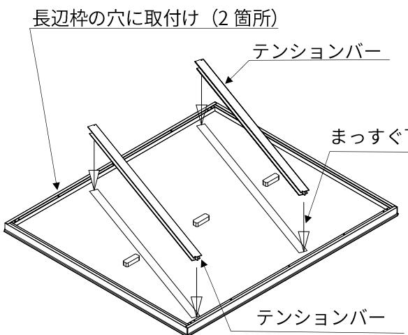
図4-1. テンションバーの取付け
