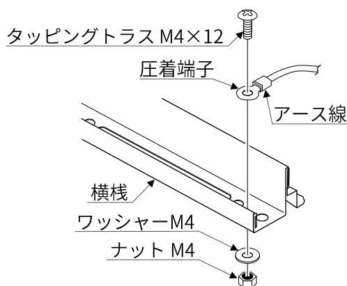
図 5-2. YS II での架台のアース接続
