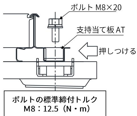
図3-10. YSIII工法 横桟の固定図
