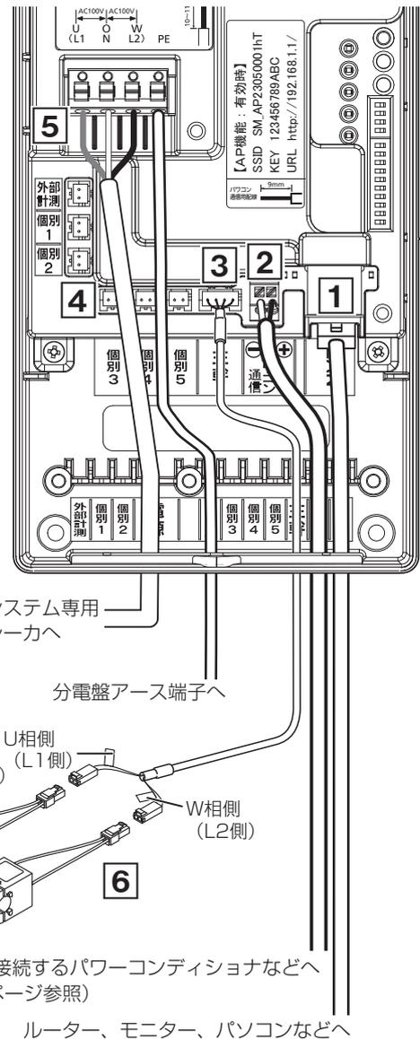
分電盤太陽光発電システム専用
