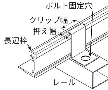
図 6-b. レールと長辺枠が垂直の場合
