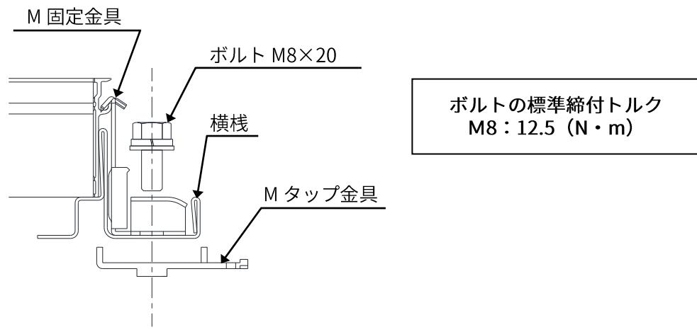
図 3-3. YS II 工法 金具の固定図
