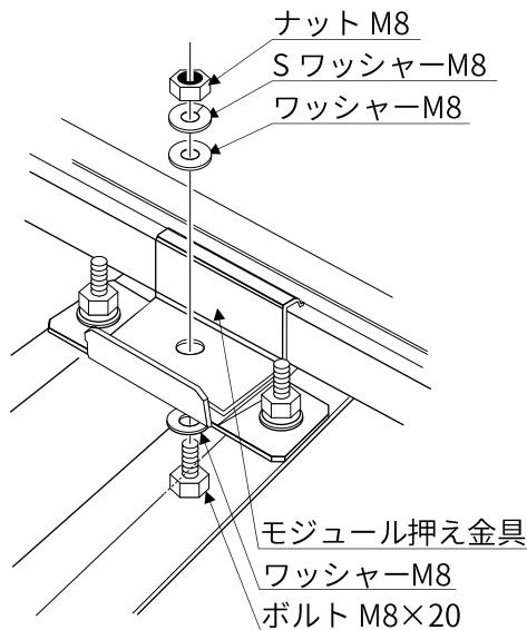
図3-16. 折板屋根工法 軒先側
