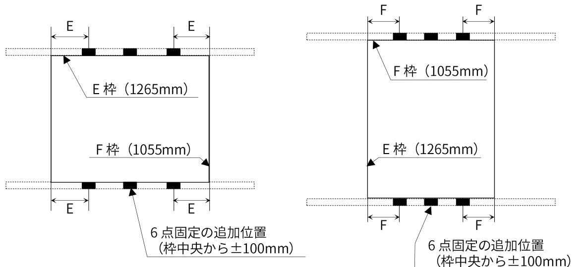
モジュール E 枠の端から  $215 \pm 115$ mm の範囲内 ( $100\text{mm} < E < 330\text{mm}$ )
