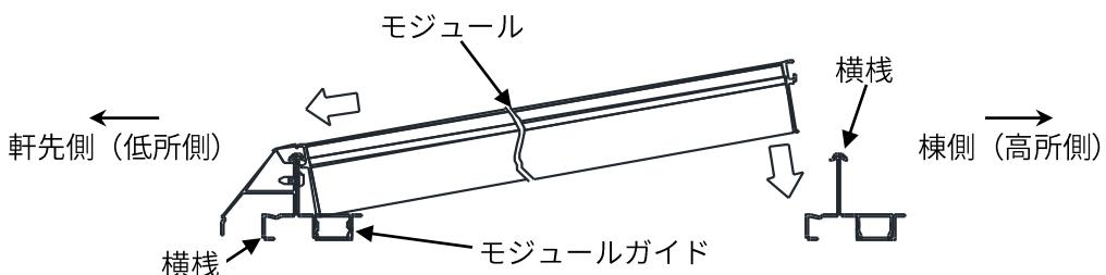
図3-6. YSIII工法 モジュール固定図
