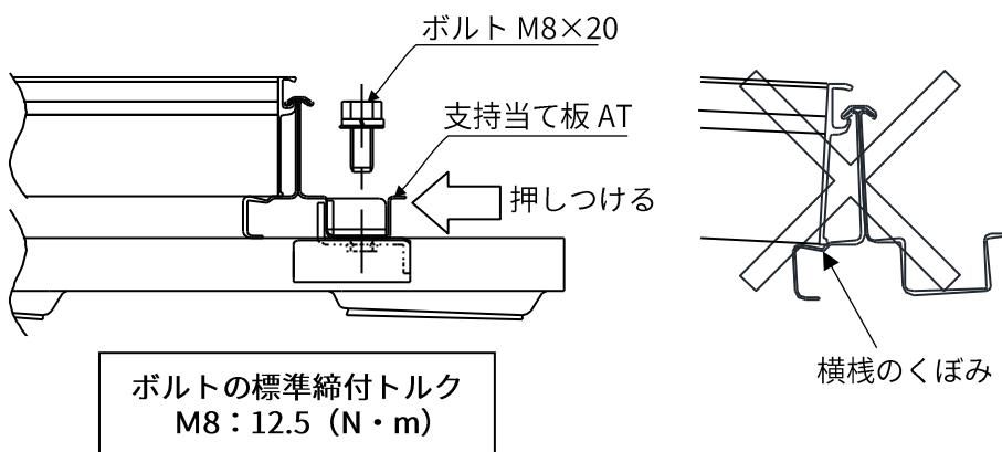
図3-10. YSIII工法 横桟の固定図
