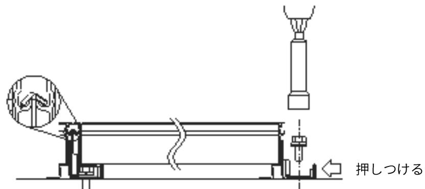
図 3-2. YS II 工法 モジュール固定図
