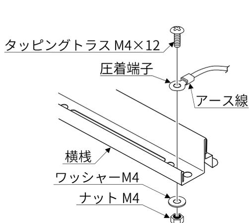
図 6-1. YSII での架台のアース接続
