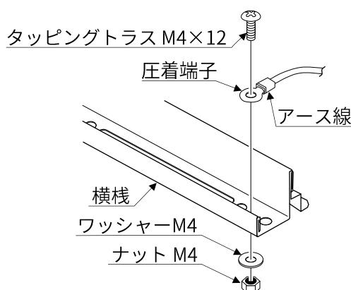
図4-1. YS IIでの架台のアース接続
