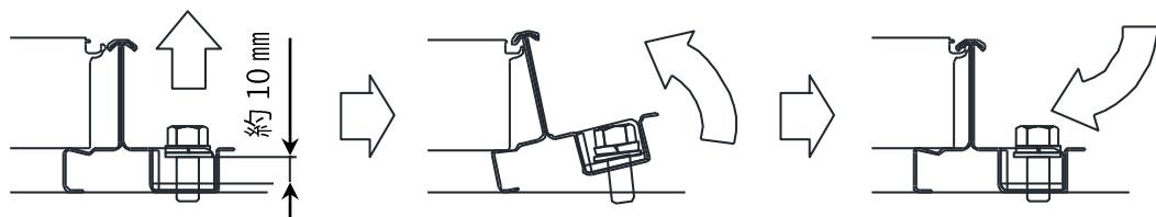
図3-7. YSIII工法 モジュール固定手順
