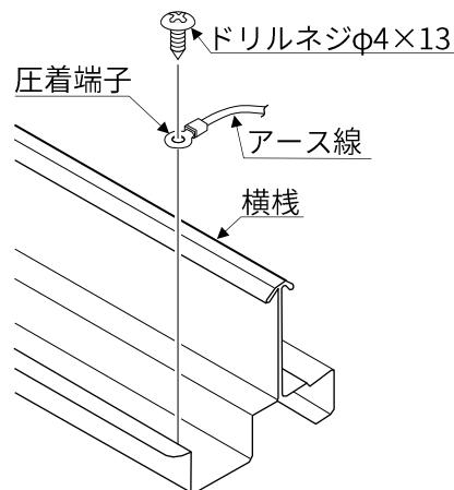
図4-2. YSIIIでの架台のアース接続
