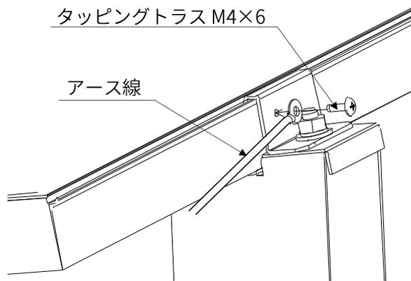
図 5-4. 折板屋根での架台のアース接続例
