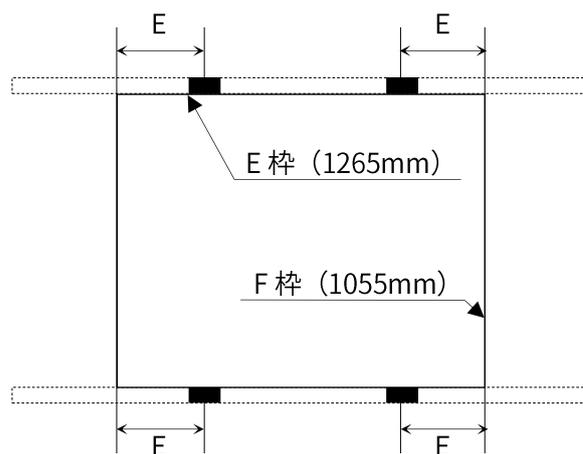
モジュール E 枠の端から 200±100mm の範囲内 (100mm < E < 300mm)
