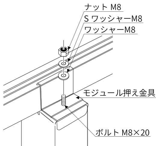
図 3-17. 折板屋根工法 棟側
