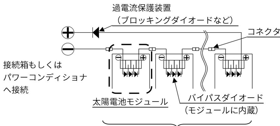
太陽電池モジュールを直列接続したものをストリングと呼びます。
