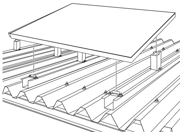
図 3-14. 折板屋根工法 モジュール固定図
