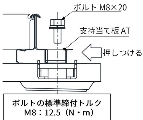
図 3-10. YSIII工法 横棧の固定図
