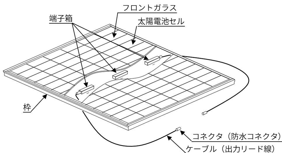
図 1. 太陽電池モジュール構成図
