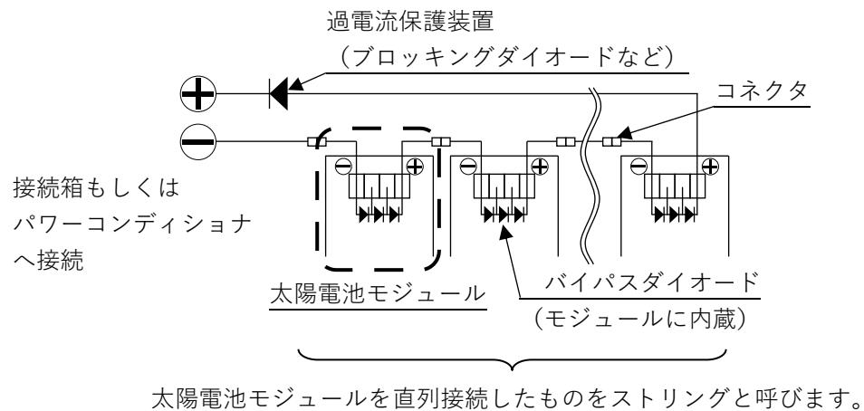
図 2. 太陽電池モジュールの配線構成例
