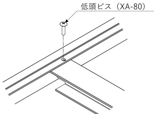
図 4-3. テンションバーの取付け部拡大図
