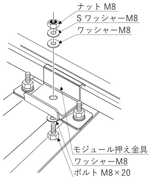
図 3-16. 折板屋根工法 軒先側
