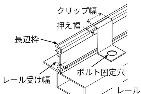
図 6-a. レールと長辺枠が平行の場合
