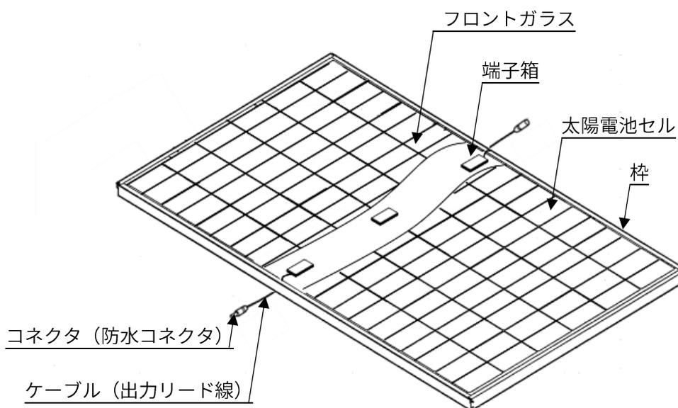
図1. 太陽電池モジュール構成図
