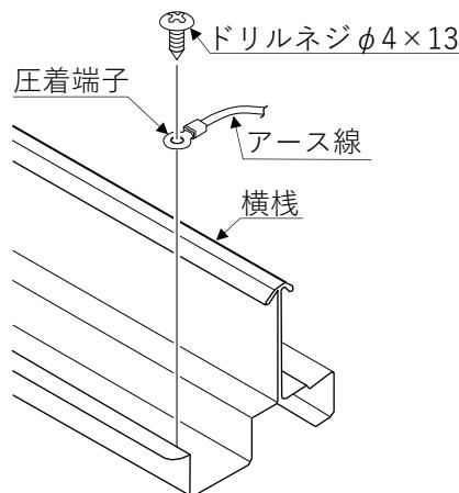
図 6-2. YS III での架台のアース接続
