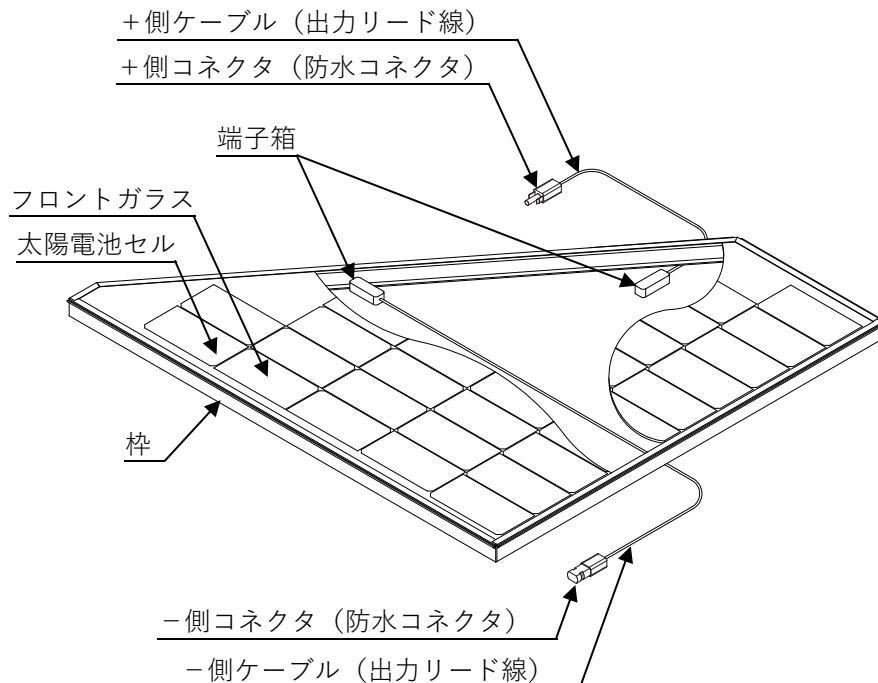
※本製品のケーブルは+側と-側で長さが異なります。接続するケーブル同士が届く範囲にあることを十分ご確認のうえ、配置してください。詳細は設置工事マニュアル、架台同梱の設置注意書面をご確認ください。
