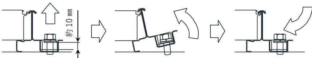
図3-7. YSⅢ工法 モジュール固定手順
