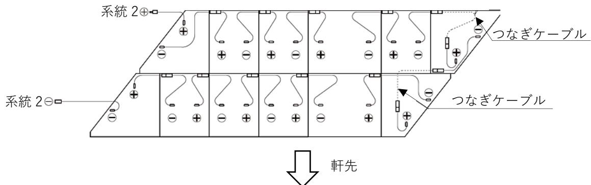
図 4. つなぎケーブルの接続例
