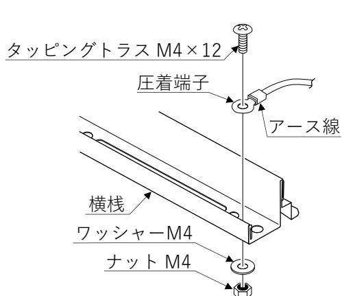
図 6-1. YS II での架台のアース接続
