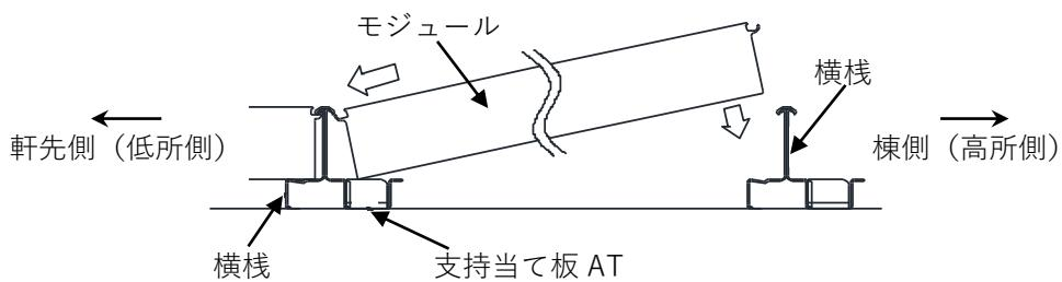
図3-6. YSⅢ工法 モジュール固定図
