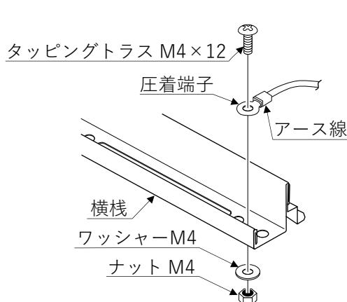
図4-1. YS IIでの架台のアース接続
