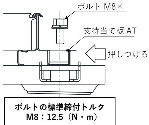
図 3-10. YSⅢ工法 横桟の固定
