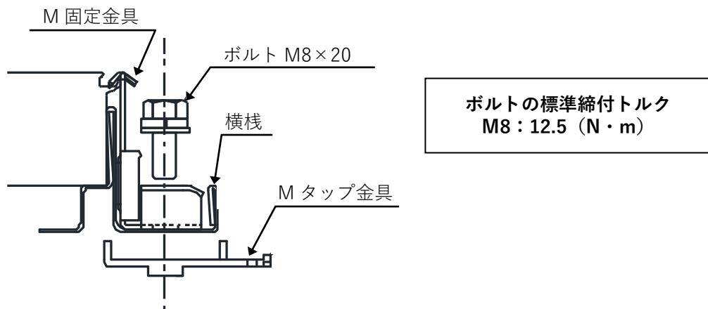
図 3-3. YS II 工法 金具の固定図
