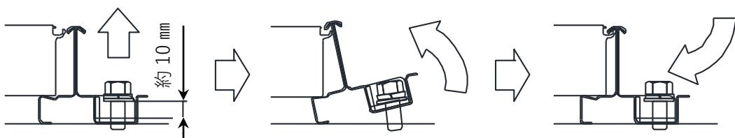
図3-7. YSⅢ工法 モジュール固定手順
