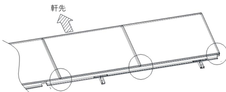
図3-8. YSⅢ工法 モジュール固定手順
