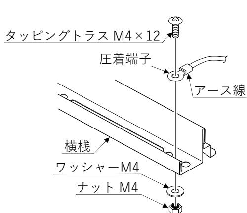
図 5-2. YS II での架台のアース接続
