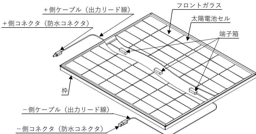
※本製品のケーブルは+側と-側で長さが異なります。接続するケーブル同士が届く範囲にあることを十分ご確認のうえ、配置してください。詳細は設置工事マニュアル、架台同梱の設置注意書面をご確認ください。
