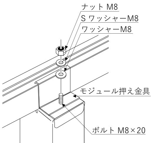
図 3-17. 折板屋根工法 棟
