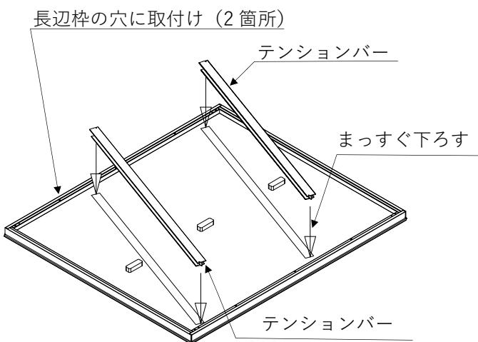
図 4-1. テンションバーの取付け
