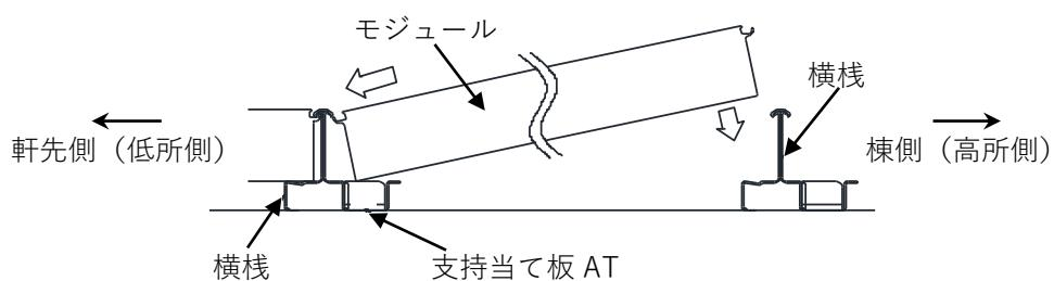
図 3-6. YS III 工法 モジュール固定図
