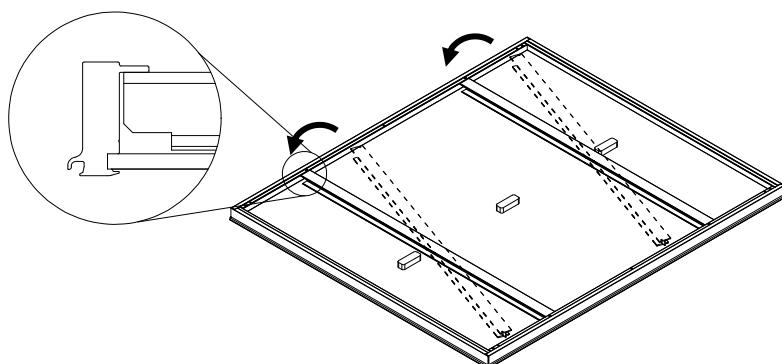
図 4-2. テンションバー取付け完成図
