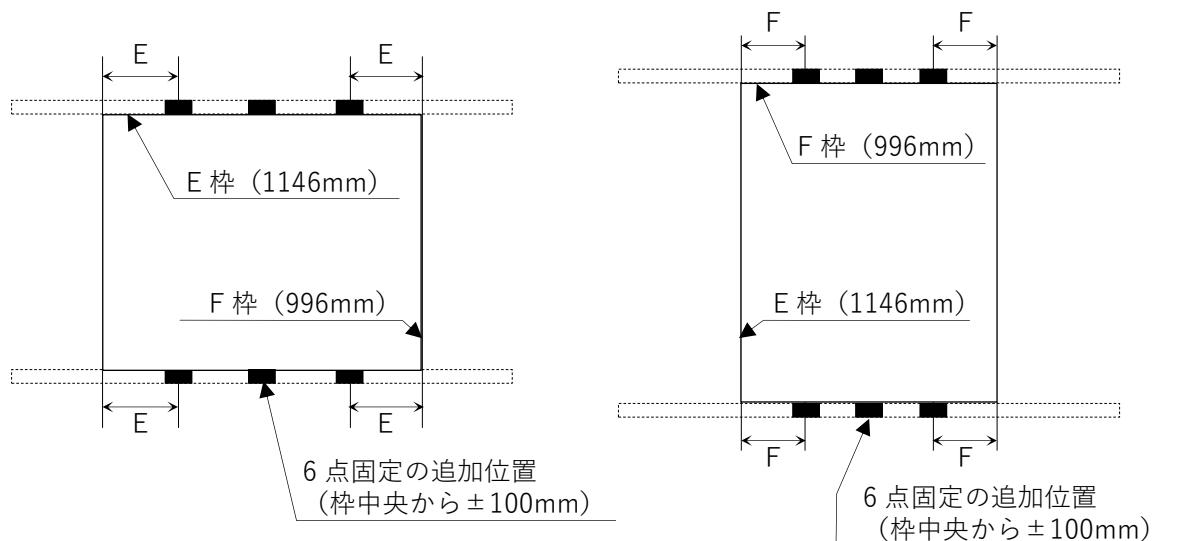
モジュール E 枠の端から  $200 \pm 100\text{mm}$
