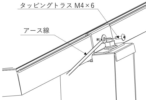
図 5-4. 折板屋根での架台のアース接続例
