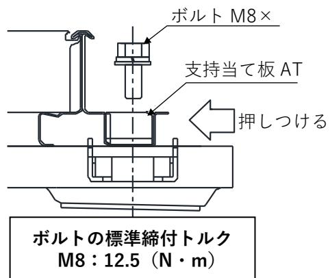
図 3-10. YSⅢ工法 横桟の固定
