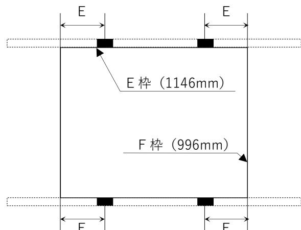
モジュール E 枠の端から  $200 \pm 100\text{mm}$
