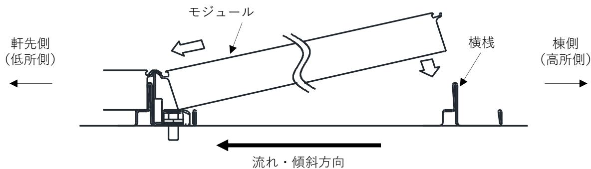
図 3-1. YS II 工法 モジュール固定図
