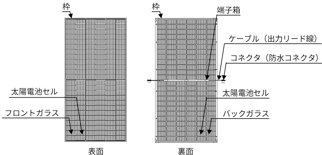
図 1. 太陽電池モジュール構成図
