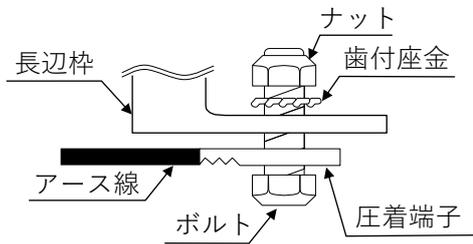
※亜鉛めっきクロメート処理されたボルト・ナットやステンレスボルトなどの使用を推奨します。なお電食に十分留意の上、材料を選定ください。
