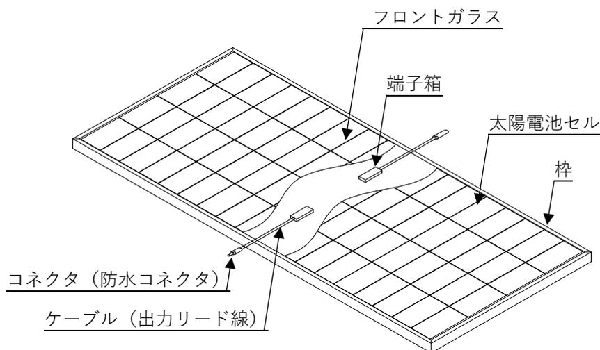
図1. 太陽電池モジュール構成図
