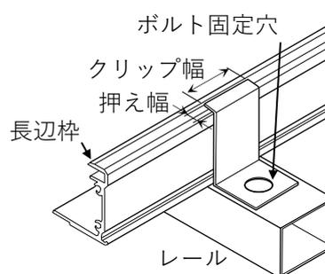
図 6-b. レールと長辺枠が垂直の場合
