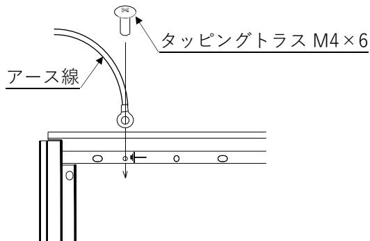
図 5-1. モジュール枠での架台のアース接続
