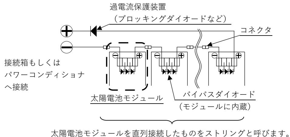
太陽電池モジュールを直列接続したものをストリングと呼びます。
