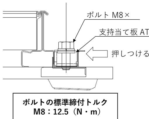
図 3-10. YSⅢ工法 横桟の固定
