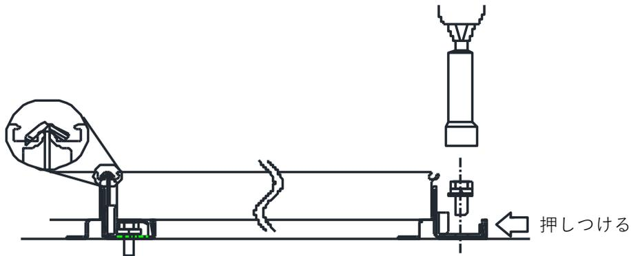
図 3-2. YS II 工法 モジュール固定図
