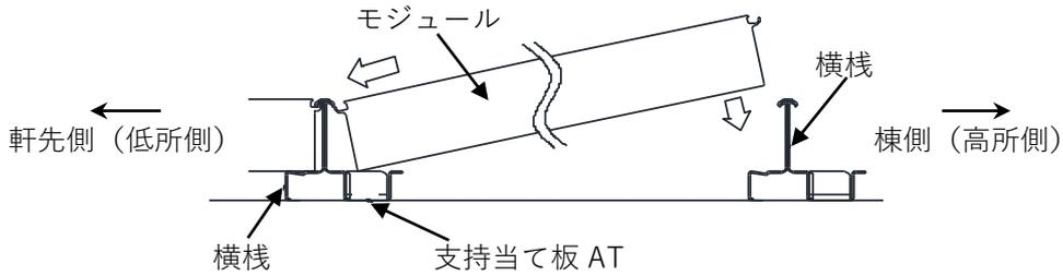
図 3-6. YSIII工法 モジュール固定図
