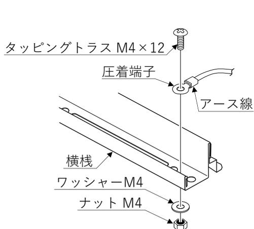
図 5-2. YS II での架台のアース接続
