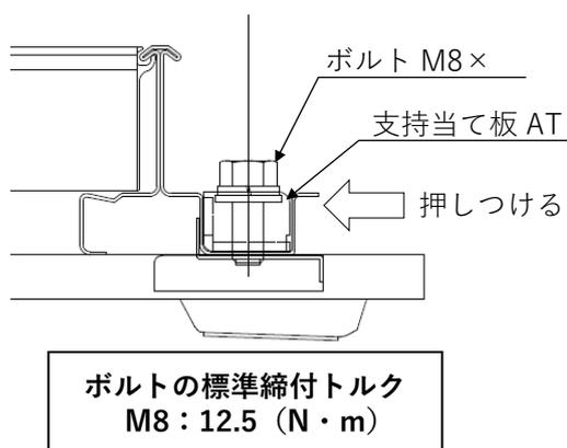
図 3-10. YSIII工法 横棧の固定
