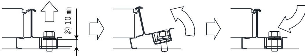
図 3-7. YSIII工法 モジュール固定手順
