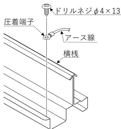
図 5-3. YS III での架台のアース接続
